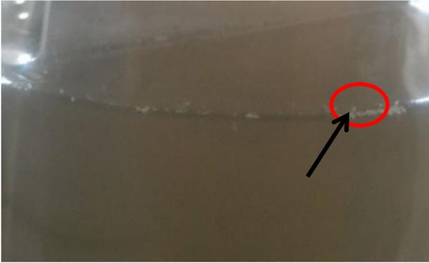
**Gambar 3.** Gelembung-gelembung Gas Hidrogen pada Proses Elektrokoagulasi
