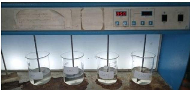
**Gambar 2.** Proses Koagulasi flokulasi Menggunakan *Jar Test*
