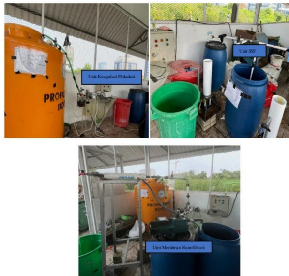
Gambar 4. Rangkaian Reaktor Teknologi Membran Nanofiltrasi Skala Pilot
