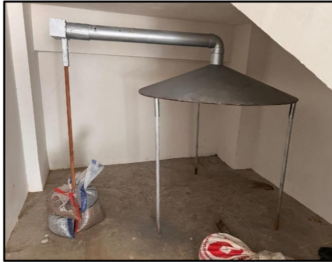
Gambar 3 Susunan Alat Penelitian Uji Kinerja Tungku Biomassa TLUD
