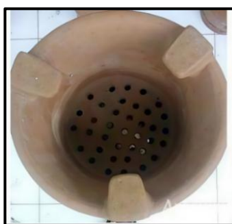
Gambar 20 Lubang udara pada tungku biomassa
